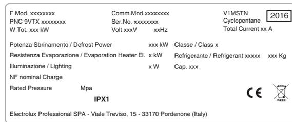
Das Typenschild enthält die Kenndaten und die technischen Daten der Maschine.
