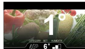
Ein längerer Tastendruck ermöglicht die Kategorieauswahl und Eingabe der entsprechenden Sollwerte. Die Taste bleibt zur Anzeige der Auswahl gedrückt. Am Display erscheint die Screensaver-Seite (siehe Abschnitt C.1.2 „Beschreibung der Screensaver-Seite“).
