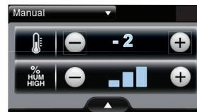
Die Funktion Manual ermöglicht das Einstellen, Bearbeiten und Speichern bestimmter Werte. Es kann zum Beispiel der Feuchtigkeitsanteil oder die Zelltemperatur geändert werden. (nur bei Kühlmodellen)
