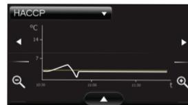
Die Funktion HACCP ermöglicht die Anzeige des Temperaturverlaufs bezüglich des eingestellten Sollwertes. Der Zoom zeigt die Temperaturänderung in Stunden oder in Tagen an. Die seitlichen Pfeile ermöglichen die Bewegung nach rechts oder nach links.
