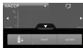
Mit der ersten Taste links kann man den Temperaturverlauf mit **USB-Stick** speichern; mit der Taste **RESET** kann man den Temperaturverlauf löschen; mit der Taste **UPDATE** kann die letzte Aktualisierung angezeigt werden.
