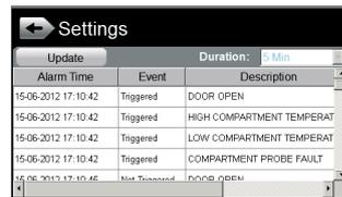
Zeigt die Liste der aufgetretenen Alarme, sowohl der laufenden als auch der beendeten Alarme. Die Anzeige der Alarme erfolgt gefiltert nach der Zeit, die ab Alarmeintritt vergangen ist. Drücken Sie zur Auswahl des anzuzeigenden Zeitraums das Pull-Down-Menü neben dem Feld **DURATION**.
