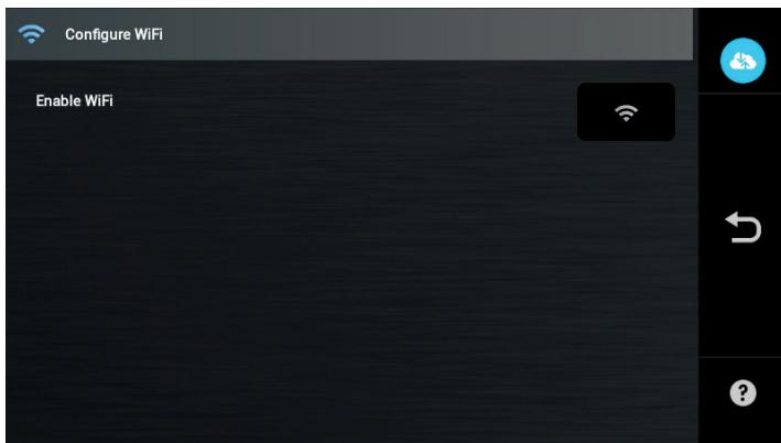
Das Symbol **“WI-FI freigeben”** zum Zugang zu den verfügbaren WI-FI-Netzen drücken.
