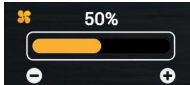
Durch Touchscreen einstellbar. Bei rechts scrollen, nimmt der Wert zu, bei links scrollen nimmt er ab. Für eine genaue Einstellung [+] drücken, um den Wert um eine Einheit zu erhöhen oder [-], um den Wert um eine Einheit zu verringern.
