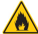
Dieses Symbol kennzeichnet das darin enthaltene Kältemittel der Pflanze Maschine ist brennbar daher zu stellen besondere Aufmerksamkeit im Schadensfall der Pflanze bzw Rohrleitungen und Wartungsarbeiten.
