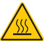
Dieses Symbol kennzeichnet die Gefahr durch heiße Oberflächen in Übereinstimmung mit den Oberflächen, auf denen es angebracht ist. In unserem Fall ist dieses Symbol außen angebracht zur Zelle, bezieht sich aber auf die inneren Oberflächen der letzteren.
